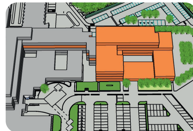
Bovenaanzicht van de nieuwe ziekenhuisvleugel: dankzij een centrale patio beschikken alle wacht- en raadplegingsruimten over natuurlijk daglicht.
